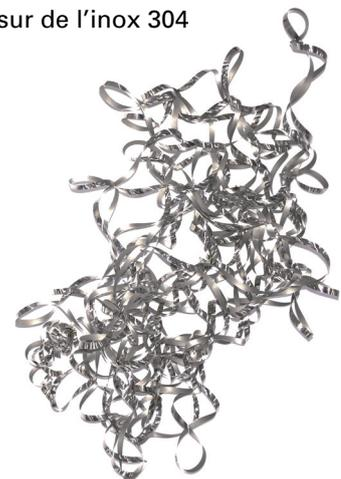
Copeaux générés avec le système LFV    Copeaux générés sans le système LFV
